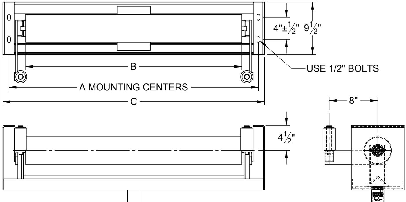
**CEMA D SELF-ALIGNING RETURN IDLER 5" DIAMETER ROLLS**
